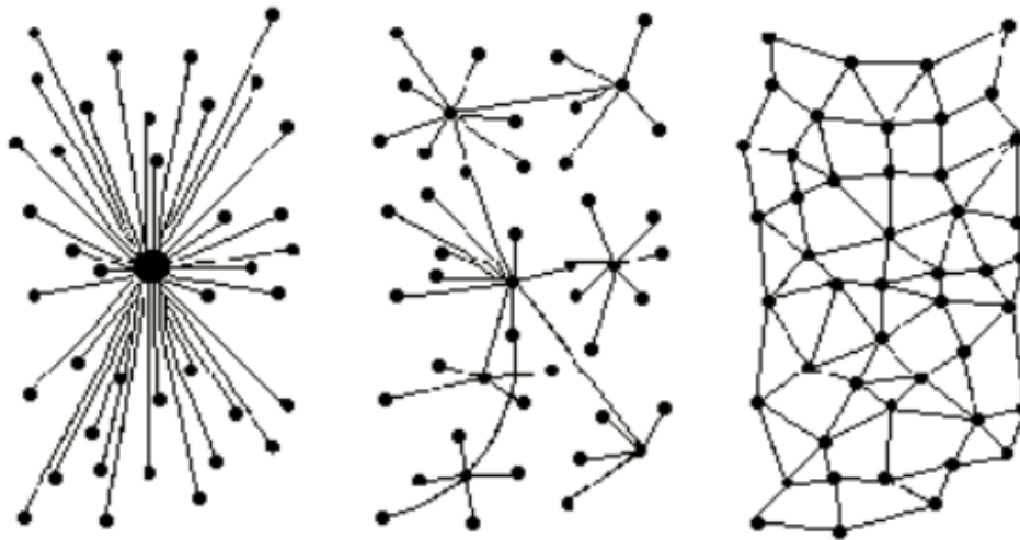
Slika 1. Centralizirani sustav, Decentralizirani sustavi, Mreža
